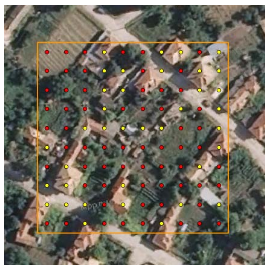
Фиг. 1. Измерване на плътността на запечатването чрез равномерна мрежа от 10x10 точки
